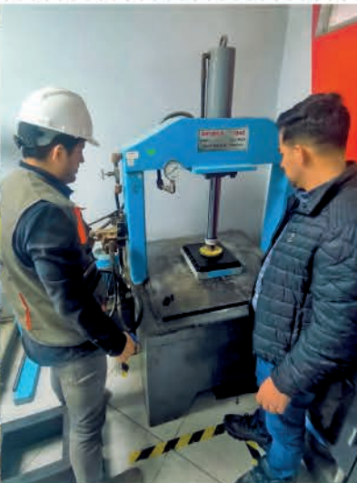
Prueba de resistencia al tránsito de marco y tapa termoplástico con visor
