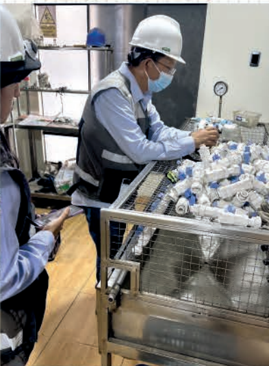
Prueba de presión de válvula con salida auxiliar y niple telescópico
