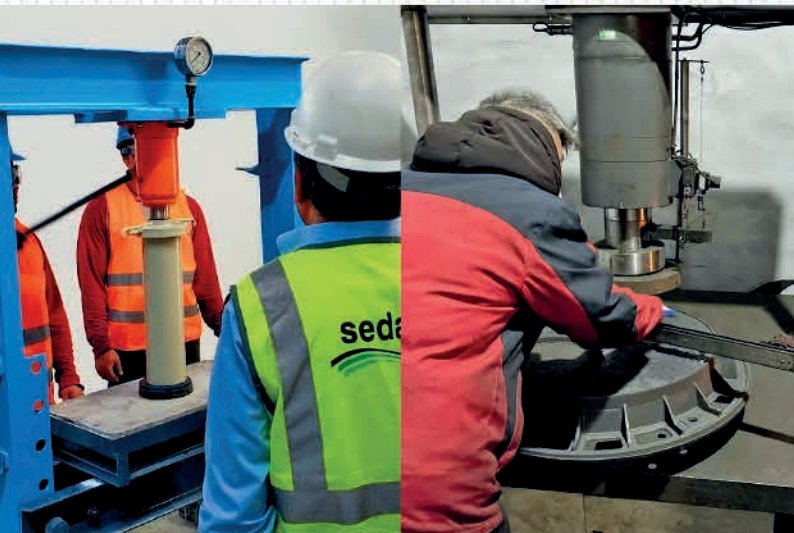
Prueba de resistencia al tránsito de tapa para registro de desagüe de 0.30x0.60m
